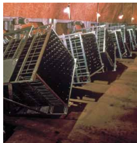
ジャイロパレット（自動ルミュアージュ装置）
